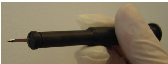
Figure 3-70. Lame d'incision insérée dans le logement du porte-lame
