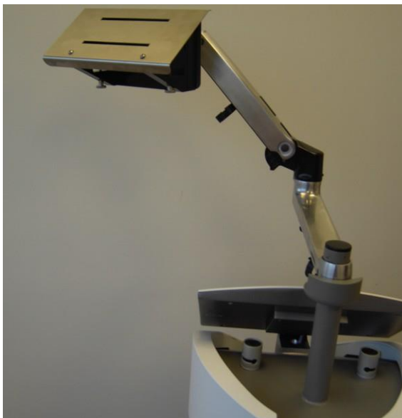
Figure 3-13. Plateau de pièce à main installé
