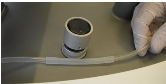
Figure 3-88. Positionnement de l'insert épais du tuyau d'implantation à côté de l'électrovanne droite
