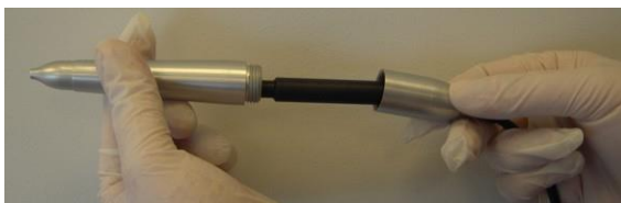
Figure 3-72. Insertion du corps de la pièce à main dans le porte-lame
