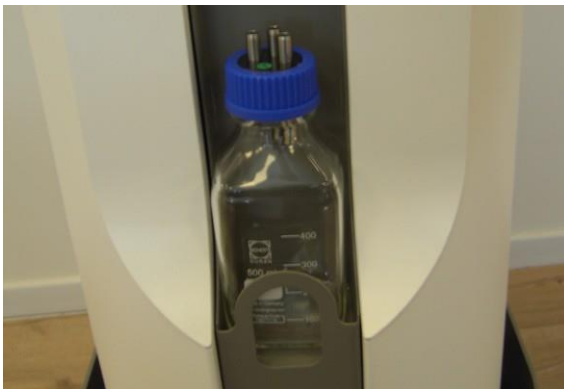
Figure 3-36. Bocal à déchet placé dans son logement, sur le système
