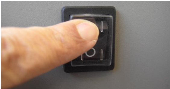
Figure 5-1. Mise en position de marche de l'interrupteur
