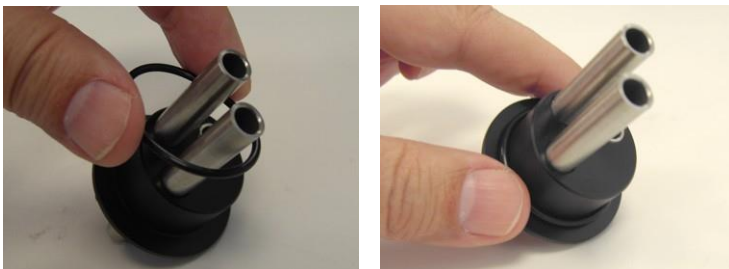
Figure 3-31. Installation du joint en caoutchouc sur la butée
