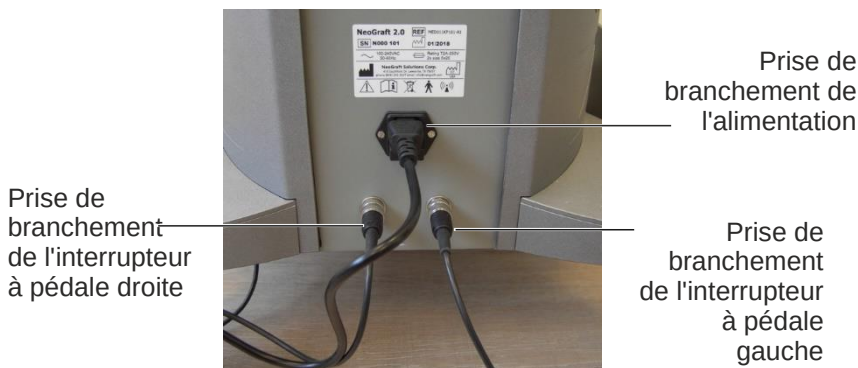
Figure 4-4. Composants du système (partie arrière inférieure)
