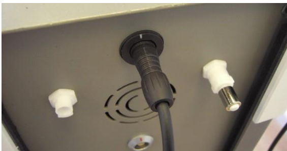
Figure 3-68. Câble de la pièce à main connecté
