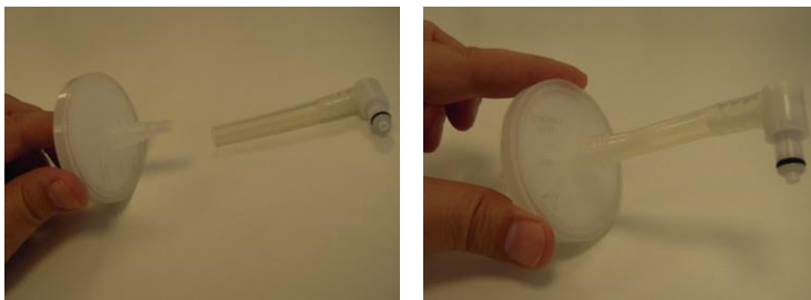
Figure 3-39. Raccordement du long tube et du raccord au porte d'admission du filtre
