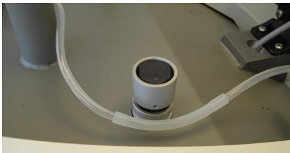
Figure 3-63. Placement de l'insert épais du tuyau d'extraction à côté de l'électrovanne gauche
