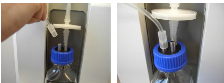
Figure 3-61. Raccordement du tuyau d'extraction au bocal
