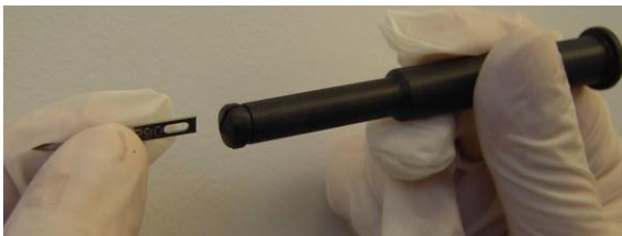
Figure 3-69. Insertion de la lame d'incision dans le logement du porte-lame
