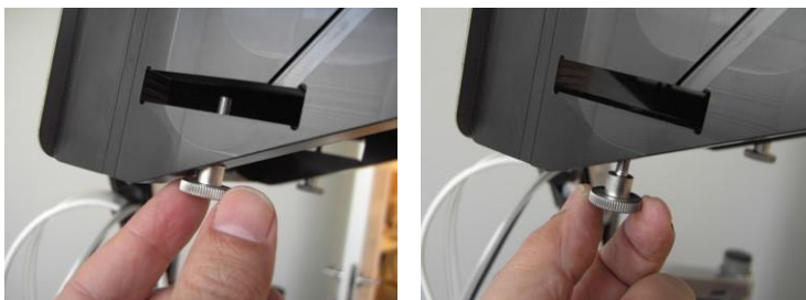
Figure 3-18. Desserrage de la vis moletée du porte-gobelet
