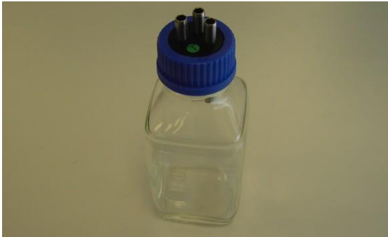
Figure 3-35. Bocal à déchet assemblé
