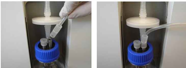
Figure 3-87. Raccordement de l'extrémité proximale de la tubulure d'implantation au bocal
