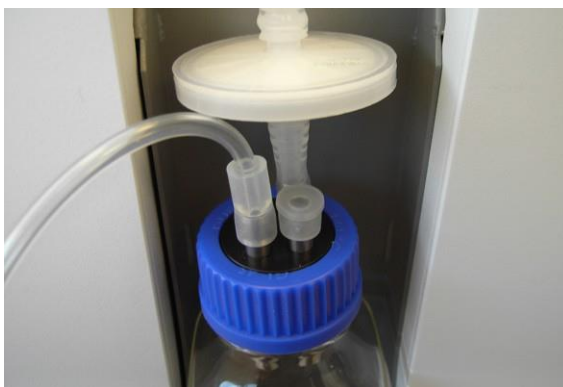
Figure 3-62. Bouchon en silicone placé sur le tube d'admission non utilisé du bocal à déchet
