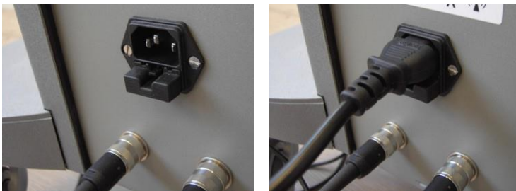
Figure 3-92. Prise de branchement d'alimentation secteur à l'arrière du système
