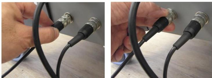
*Figura 3-29. Collegamento del cavo dell'interruttore a pedale di destra al relativo connettore sulla parte posteriore del sistema*
