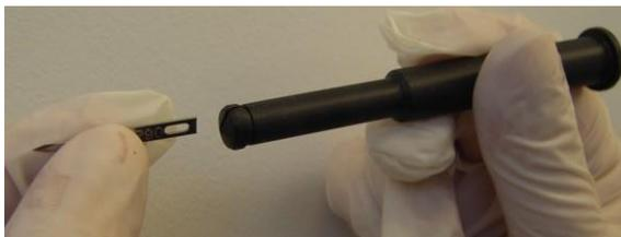
*Figura 3-69. Inserimento della lama per incisione nell'alloggiamento del supporto per la lama*
