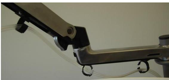
*Figura 3-91. Tubi del manipolo per impianto inseriti nei supporti per cavo/tubi del braccio articolato*
