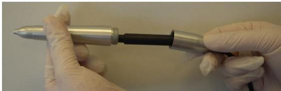
*Figura 3-72. Inserimento del corpo del manipolo sul supporto per la lama*
