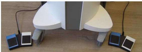
*Figura 4-6. Interruttori a pedale di sinistra e di destra*
