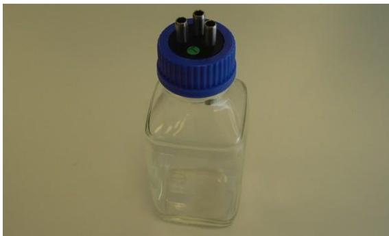
*Figura 3-35. Flacone per gli scarti montato*
