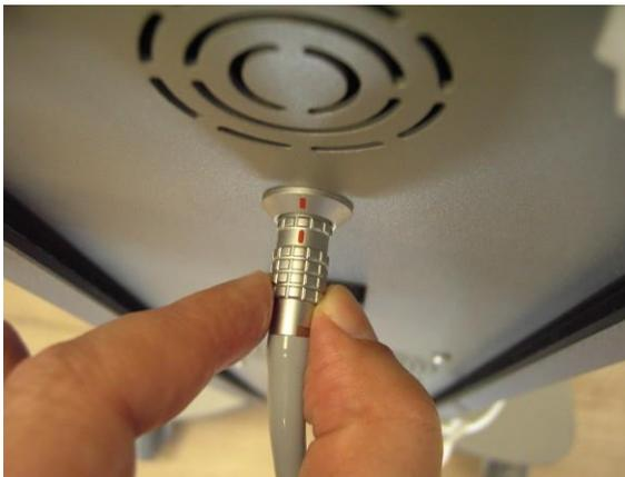
*Figura 3-46. Collegamento del connettore del cavo del manipolo*
