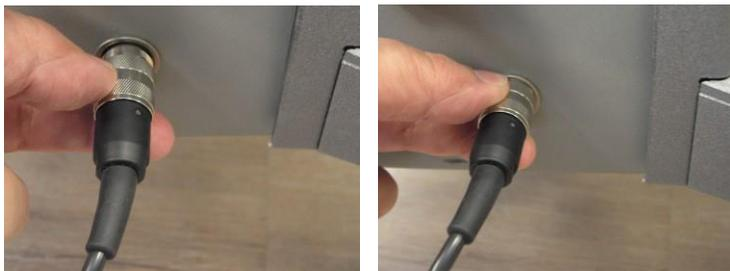
*Figura 3-25. Collegamento del cavo dell'interruttore a pedale di sinistra al relativo connettore sulla parte posteriore del sistema*
