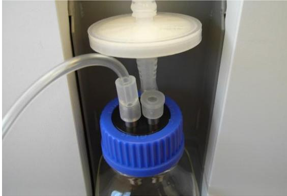
*Figura 3-62. Tappo di silicone applicato al tubo di ingresso del flacone per gli scarti non utilizzato*
