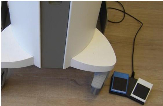
*Figura 3-27. Interruttore a pedale di destra posizionato a destra del sistema*
