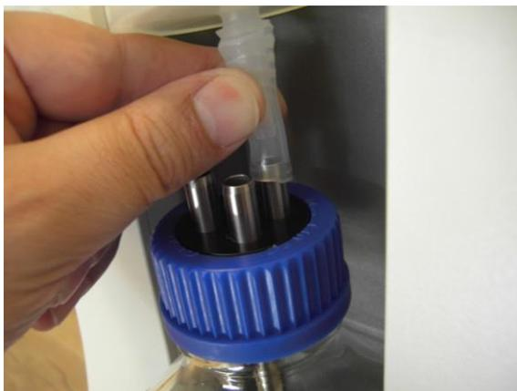
*Figura 3-42. Collegamento del tubo a vuoto al flacone per gli scarti*
