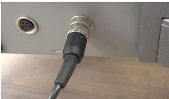
*Figura 3-26. Cavo dell'interruttore a pedale di sinistra collegato*
