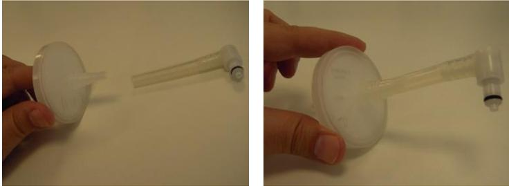
*Figura 3-39. Collegamento della porzione più lunga del tubo e collegamento alla porta di ingresso del filtro*
