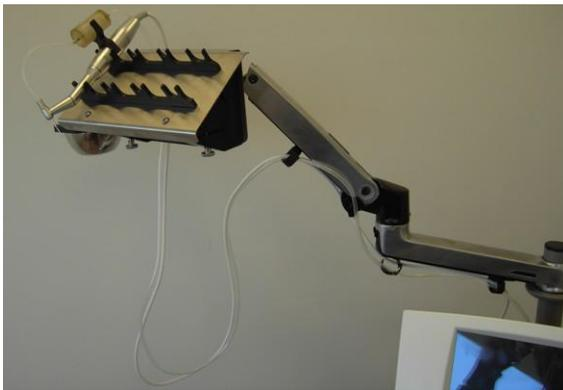
*Figura 3-66. Cavo e tubi del manipolo di estrazione inseriti nei supporti per cavo/tubi del braccio articolato*
