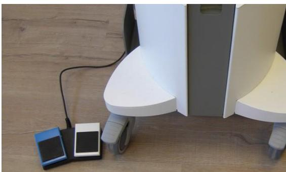
*Figura 3-23. Interruttore a pedale di sinistra posizionato a sinistra del sistema*
