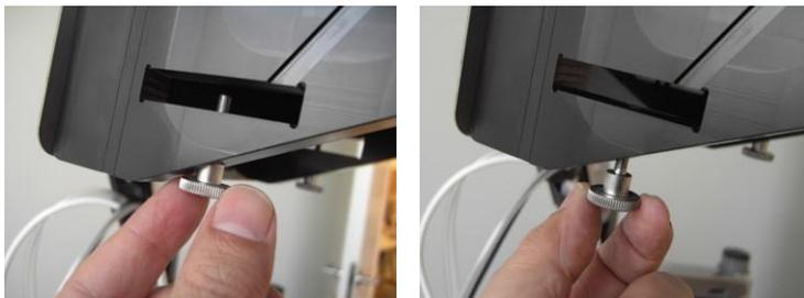
*Figura 3-18. Allentamento della vite a testa zigrinata del supporto della tazza*
