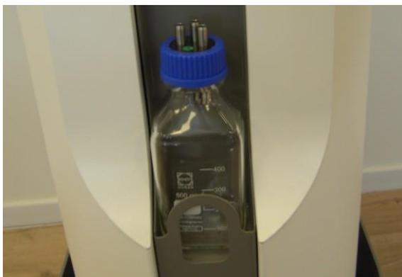
*Figura 3-36. Flacone per gli scarti posizionato nell'apposito alloggiamento del sistema*
