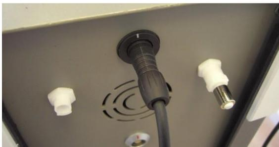
*Figura 3-68. Cavo del manipolo collegato*
