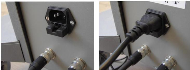
*Figura 3-92. Presa di collegamento dell'alimentazione sulla parte posteriore del sistema*
