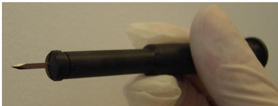
*Figura 3-70. Lama per incisione inserita nel supporto per la lama*
