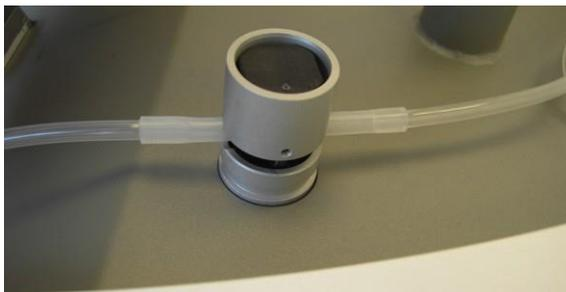
*Figura 3-90. Tubo per impianti inserito nell'elettrovalvola di destra*
