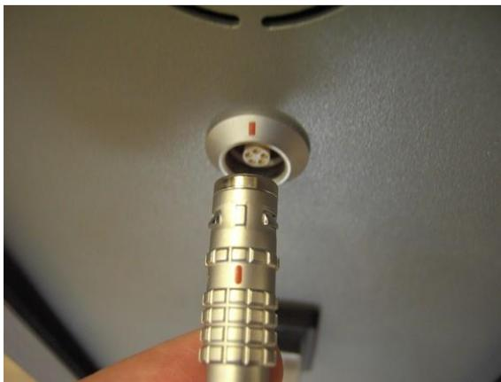
*Figura 3-45. Allineamento del segno rosso sul connettore del cavo del manipolo al segno rosso sulla presa*
