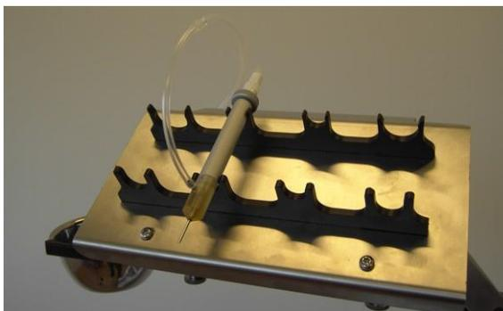
*Figura 3-84. Posizionamento del manipolo per impianto sul supporto del manipolo*
