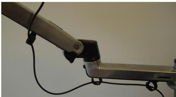
*Figura 3-77. Cavo del manipolo per incisione inserito nei supporti per cavo/tubi del braccio articolato*
