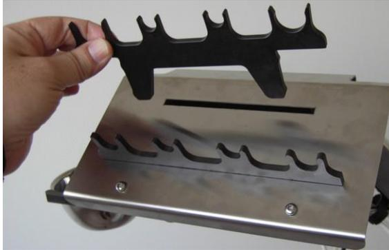
*Figura 3-16. Inserimento del supporto superiore del manipolo*
