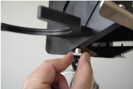
*Figura 3-20. Avvitamento della vite a testa zigrinata del supporto della tazza*
