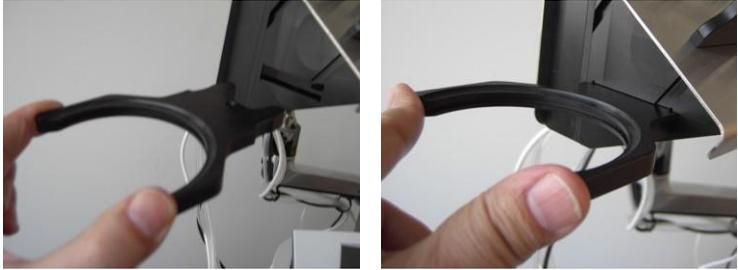
*Figura 3-19. Inserimento del supporto della tazza nell'apposito alloggiamento*
