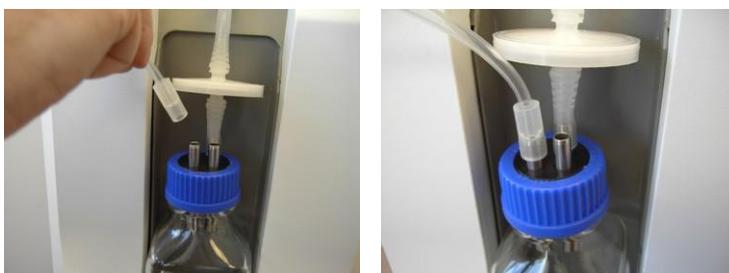
*Figura 3-61. Collegamento del tubo di estrazione al flacone*
