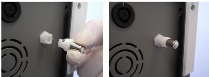
*Figura 3-86. Collegamento di un tappo Luer Lock per prese d'aria alla porta di uscita dell'aria n. 2 del sistema di sinistra*
