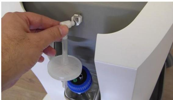
*Figura 3-41. Collegamento del gruppo del filtro alla porta del vuoto del sistema*
