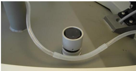
*Figura 3-63. Posizionamento della porzione più spessa del tubo di estrazione vicino all'elettrovalvola di sinistra*
