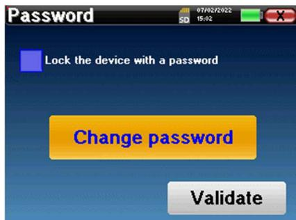
Puede acceder posteriormente a la ventana de configuración de la contraseña desde el menú "Config" y luego "Sistema". Esta ventana le permite cambiar la contraseña, pero también activar o desactivar el bloqueo. Si olvida su contraseña, póngase en contacto con Électronique du Mazet para recibir un código de desbloqueo.
