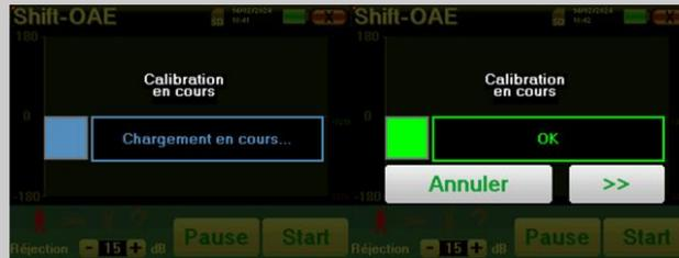
Si el campo se muestra en **verde** con la indicación «OK», la medición comenzará automáticamente.
