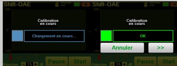
Si el campo se muestra en **verde** con la indicación **OK**, la medición comenzará automáticamente.
