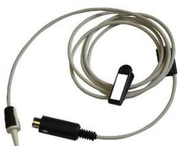
La sonda OAE permite realizar mediciones de TEOAE, DPGamma y Shift-OAE, es un elemento frágil que es importante verificar regularmente. Para ello, **ECHOSOFT** dispone de un módulo de autocomprobación que permite verificar el correcto funcionamiento de la sonda.
