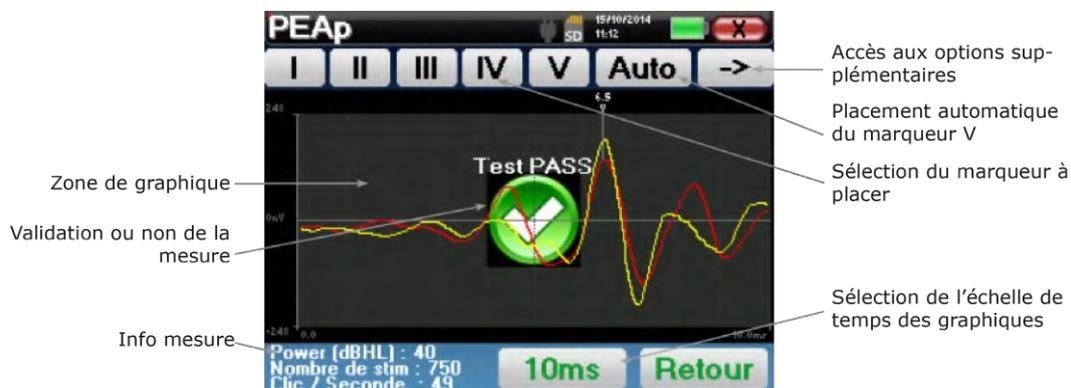
Lors de la consultation d'un **PEAp** de dépistage, la fenêtre ci-dessus s'affiche et permet de traiter les courbes. Le but premier sur un **PEAp** de dépistage est de repérer l'apparition de l'onde V à une puissance relativement basse. C'est la présence ou non de cette onde qui va permettre de donner un diagnostic positif ou négatif concernant l'audition du sujet.
