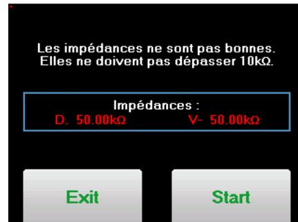
I valori delle impedenze devono essere i più bassi e il più equilibrati possibile per garantire la qualità della misurazione.
