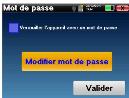
È possibile accedere alla finestra di configurazione della password in un secondo momento dal menu "Config" e poi "Sistema". Questa finestra consente di modificare la password, ma anche di attivare o disattivare il blocco. In caso di smarrimento della password, contattare Electronique du Mazet o il proprio rivenditore per ricevere un codice di sblocco.
