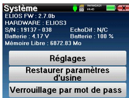
Über die Schaltfläche „Einstellungen“ gelangen Sie zum Menü zur Aktivierung der optimierten Startmodi für Bediener, die das Gerät (hauptsächlich) in Verbindung mit einem Computer (Echosoft) verwenden. Die Einstellungen ermöglichen den direkten Start des Geräts im „USB-Modus“ sowie einen automatischen Start, sobald die Verbindung zum Computer erkannt wurde.
