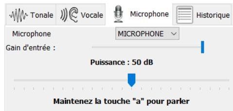
Es posible seleccionar el dispositivo de entrada (la lista de dispositivos dependerá del ordenador y de la tarjeta de sonido). Es posible ajustar la ganancia de entrada (esto dependerá del ordenador y de la tarjeta de sonido). Por último, hay que ajustar la potencia a la que se enviará el sonido a los auriculares del paciente.
