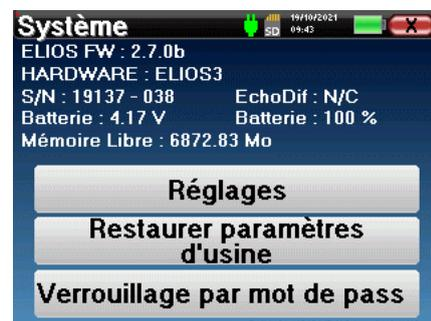
El botón «Ajustes» permite acceder al menú de activación de los modos de arranque optimizados para los operadores que utilizan (principalmente) el dispositivo conectado al ordenador (Echosoft). Los ajustes permiten iniciar el dispositivo directamente en «modo USB», así como la posibilidad de un arranque automático tan pronto como se haya reconocido la conexión con el ordenador.
