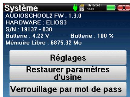
Il pulsante **"Impostazioni"** consente di accedere al menu di attivazione delle modalità di avvio ottimizzate per gli operatori che utilizzano (principalmente) il dispositivo nella versione standard collegato al computer (Echosoft). Le impostazioni consentono di avviare il dispositivo direttamente in "modalità USB" e offrono la possibilità di un avvio automatico non appena viene riconosciuta la connessione con il computer.
