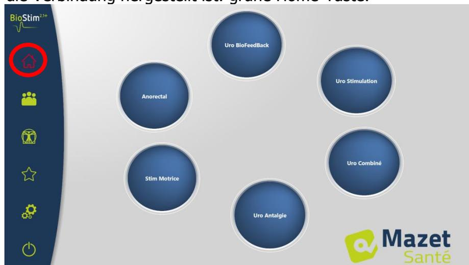
Die **rot** gefärbte Home-Taste weist auf ein Kommunikationsproblem zwischen dem PC und dem Gerät hin. Überprüfen Sie in diesem Fall die folgenden Punkte:
