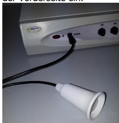
Schließen Sie das (die) Stimulationskabel je nach Anwendung an Kanal A (und B) an.
