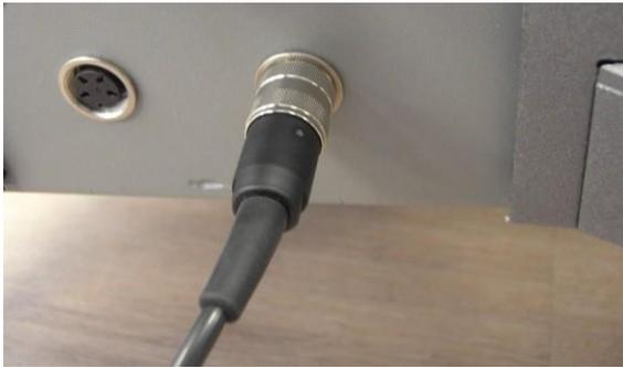
*Figura 3-26. Cable del interruptor de pie izquierdo conectado*
