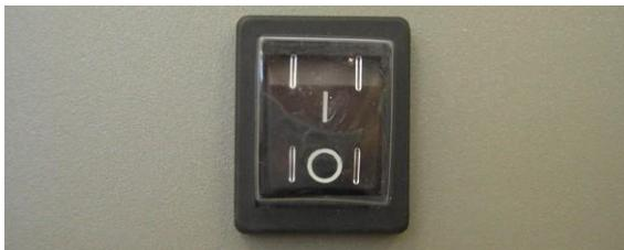
*Figura 4-8. Interruptor de encendido*
