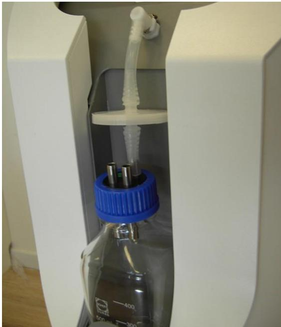
*Figura 3-44. Filtro montado instalado*
