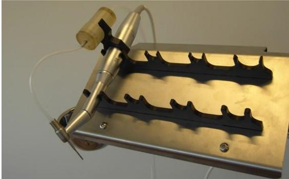
*Figura 3-60. Colocación de la pieza manual de extracción en el soporte de piezas manuales*
