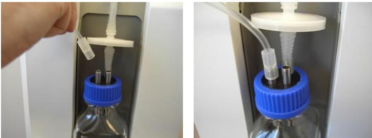
*Figura 3-61. Conexión del tubo de extracción al frasco*
