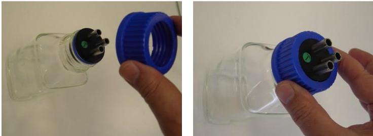
*Figura 3-34. Cierre de la tapa exterior del frasco*
