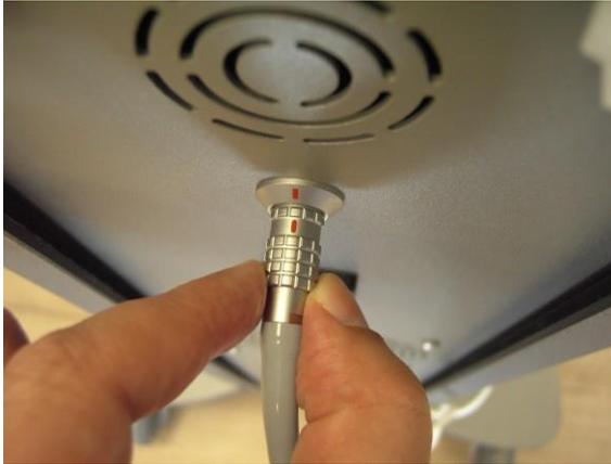
*Figura 3-46. Conexión del conector del cable de la pieza manual*
