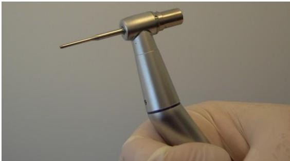
***Figura 3-53. Punzón instalado***
