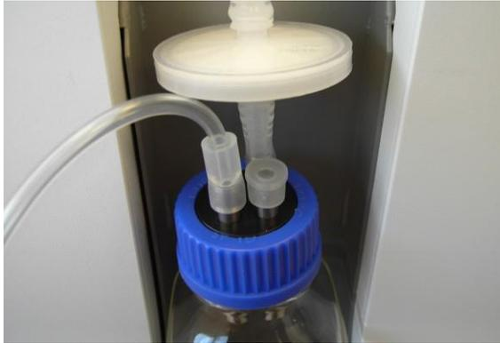
*Figura 3-62. Tapón de silicona conectado al conducto de entrada que no se utiliza del frasco de residuos*
