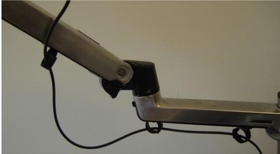
*Figura 3-77. Cable de la pieza manual de incisión en los soportes para cables y tuberías del brazo articulado*
