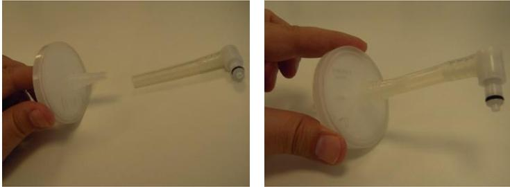
*Figura 3-39. Conexión del tubo largo y el adaptador al puerto de entrada del filtro*
