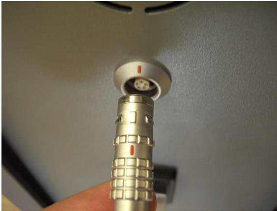
*Figura 3-45. Alineación de la marca roja del conector del cable de la pieza manual con la marca roja de la toma*
