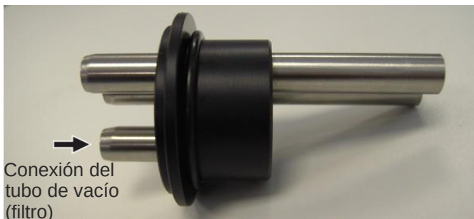
Figura 3-43. Tubo de vacío (filtro) que se conecta al conducto más corto del tapón
