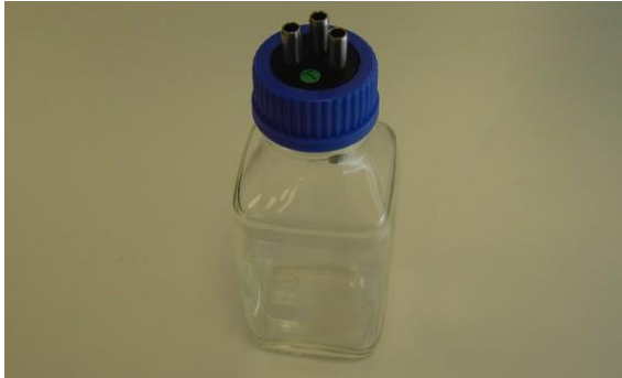
Figura 3-35. Frasco de residuos montado
