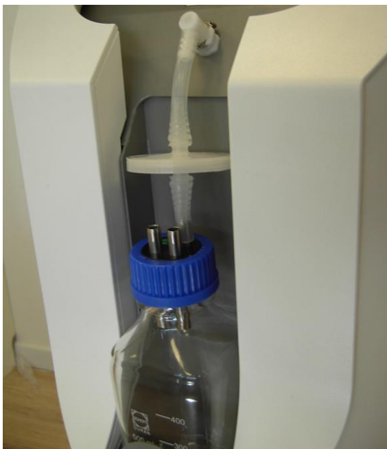
Figura 3-44. Filtro montado instalado
