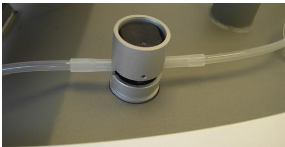
Figura 3-90. Tubo de implante insertado en la electroválvula derecha
