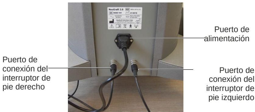
Figura 4-4. Componentes del sistema (parte trasera inferior)
