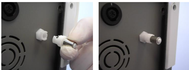
Figura 3-86. Conexión de la tapa de aire de cierre Luer al puerto n.º 2 de salida de aire del sistema
