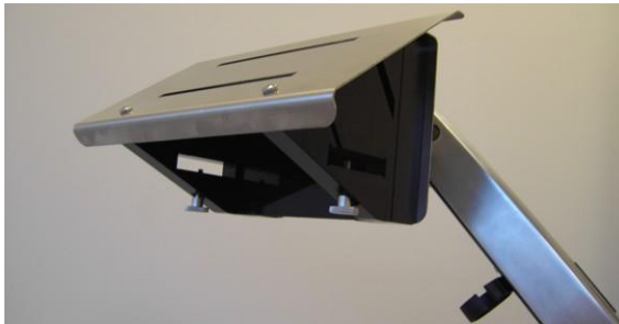
Figura 3-11. Bandeja de piezas manuales montada sobre su base
