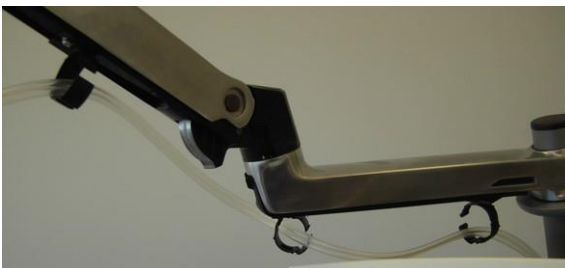
Figura 3-91. Tubería de la pieza manual de implante en los soportes para cables y tuberías del brazo articulado
