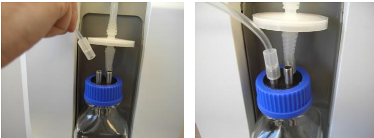
Figura 3-61. Conexión del tubo de extracción al frasco
