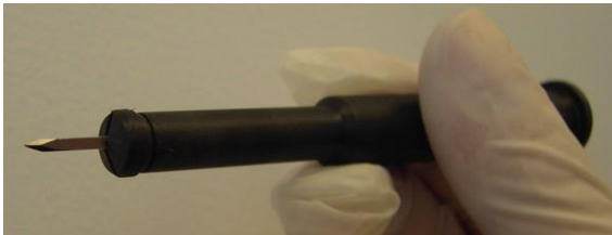
Figura 3-70. Hoja de incisión inserta en el soporte de la hoja
