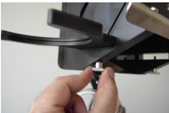
Figura 3-20. Ajuste del tornillo de apriete manual del portacubeta
