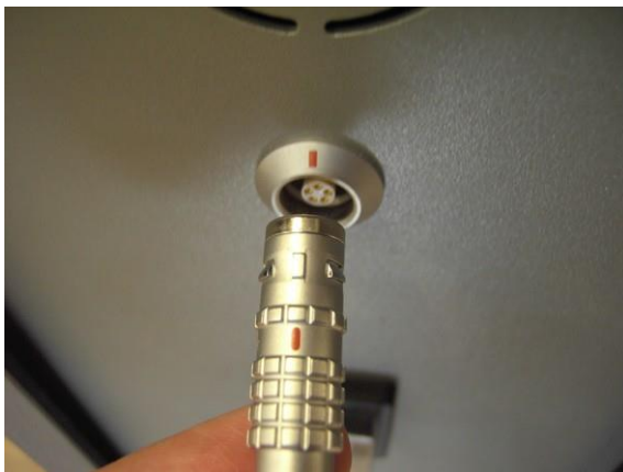
Figura 3-45. Alineación de la marca roja del conector del cable de la pieza manual con la marca roja de la toma
