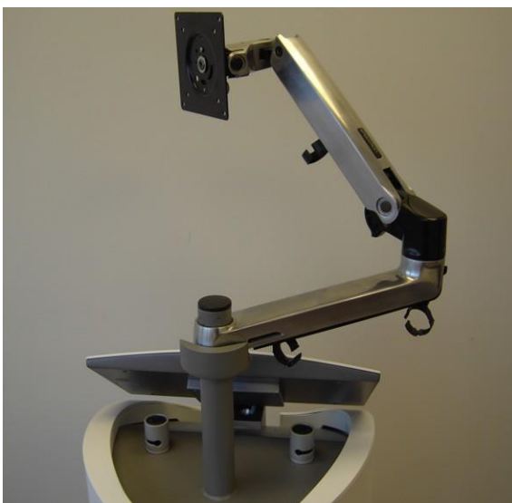
Figura 3-7. Brazo articulado instalado
