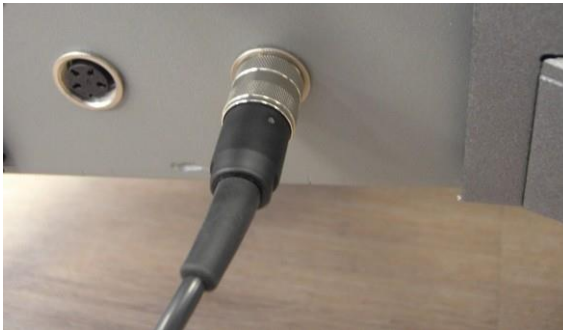
Figura 3-26. Cable del interruptor de pie izquierdo conectado
