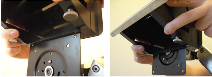
Figura 3-10. Inserción de la bandeja de piezas manuales en su base
