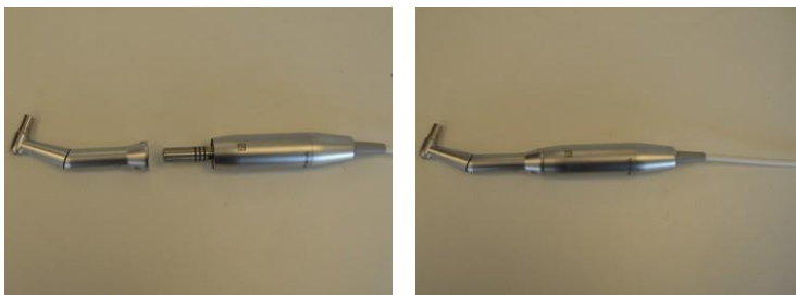
Figura 3-50. Introducción del cabezal de contraángulo en el rotor
