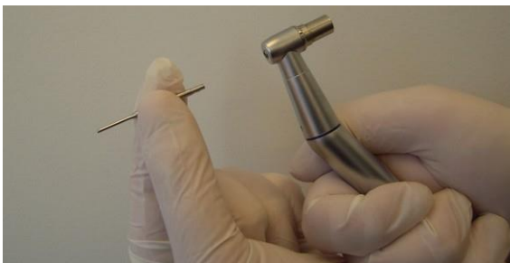
Figura 3-51. Alineación del punzón con el orificio de la pieza manual
