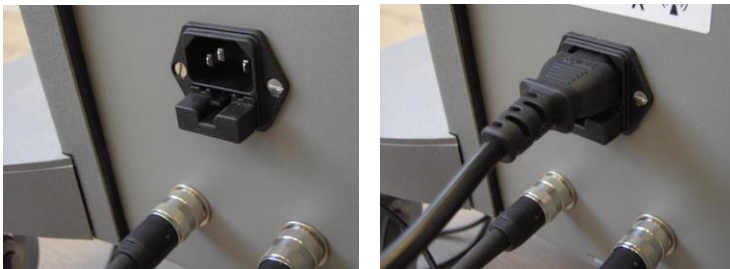
Figura 3-92. Puerto de alimentación en la parte trasera del sistema
