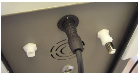
Figura 3-68. Cable de la pieza manual conectado
