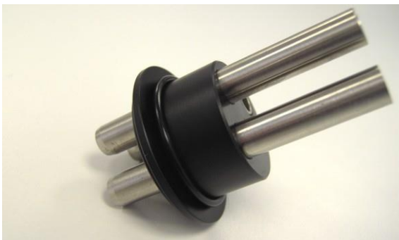
Figura 3-32. Junta de caucho instalada en el tapón
