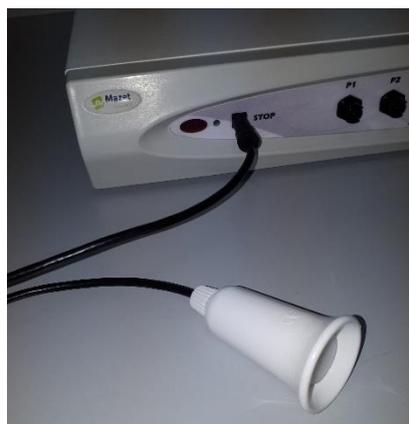
Conectar el (les) cable(s) de estimulación en la(s) vía(s) A (y B) según su aplicación.
